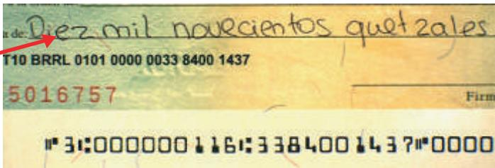
Filtraje óptico utilizado: radiación infrarroja a 780 nanómetros.
