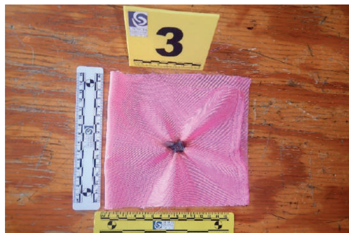
Figura 4. Fotografía con acercamiento de la muestra dañada por los productos del cortocircuito.
