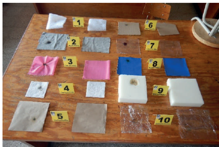
Figura 3. Fotografía de las muestras colocadas a 1 cm de distancia de la fuente del cortocircuito.
