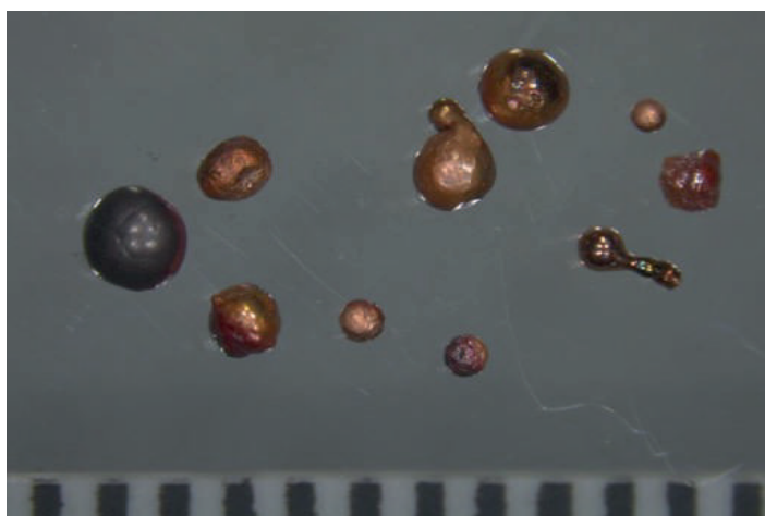
Figura 6. Fotografía de glóbulos de cobre. Un milímetro es representado por el periodo entre líneas.
