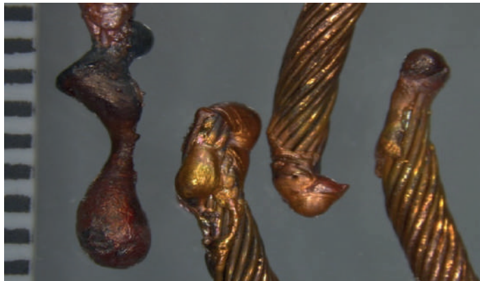
Figura 5. Fotografía de las puntas de los cables con fusión de cobre por cortocircuito.
