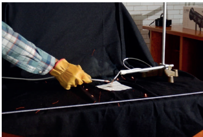
Figura 2. Fotografía de la maniobra para generar uno de los cortocircuitos sobre materiales sólidos combustibles
