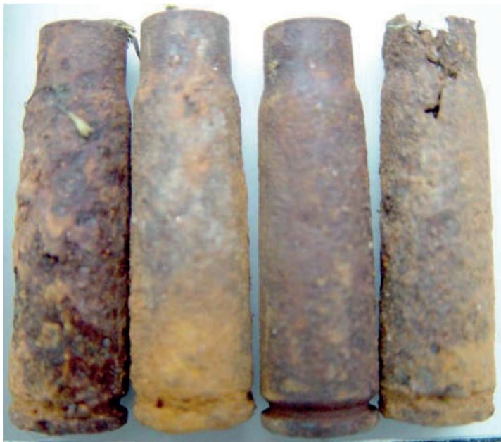
Figura 4. Casquillos dañados, no aptos para análisis comparativo. Laboratorio de Balística, -INACIF-.
