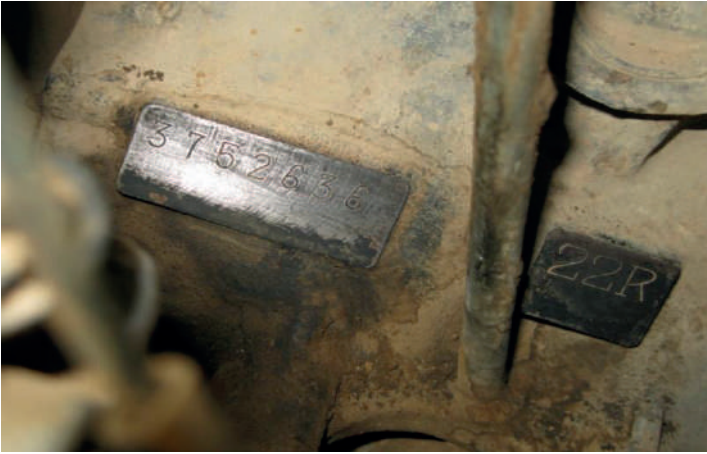
Figura 2. Identificación de motor, también conocida como número de motor.
