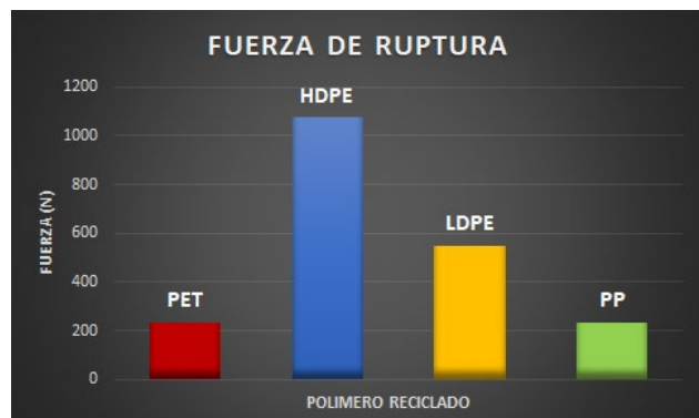
Figura 4. Módulo de ruptura de la madera plástica de acuerdo con el polímero de reciclado primario utilizado.
