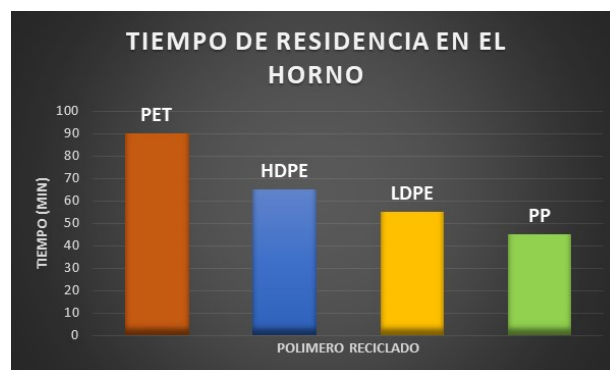
Figura 2. Tiempo de residencia en horno para el proceso de termoformado de la madera plástica.
