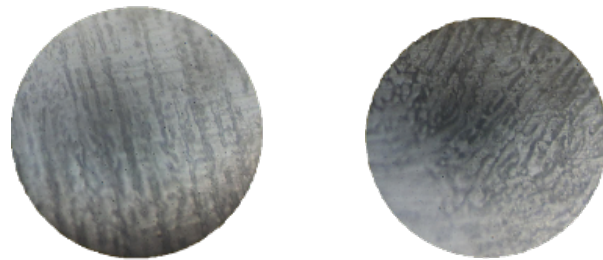
Figura 6. Micrografía de unión de acero A304 con material de aporte E308. 100X. Fuente: elaboración propia.
