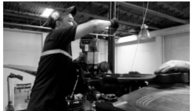
*Figura 3.* Procedimiento técnico, remoción tuerca del mástil.
