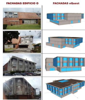
Imagen 2. Fachadas del edificio O: situación actual y modelado en eQuest. Fuente: elaboración propia, 2017.
