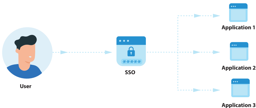
Figura 3. Esquema de trabajo bajo SSO. Tomado de Enterprise SAML-based SSO: Everything you need to know por Zoho Corporation, 2024.
