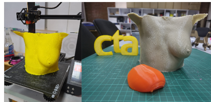
Figura 2 Modelado 3D de la prótesis para mastectomía simple impresa en 3D
