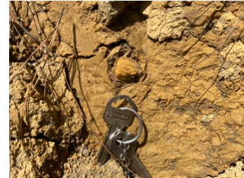
d) Concreción de hierro dentro de una matriz de suelo de textura arcillosa.
