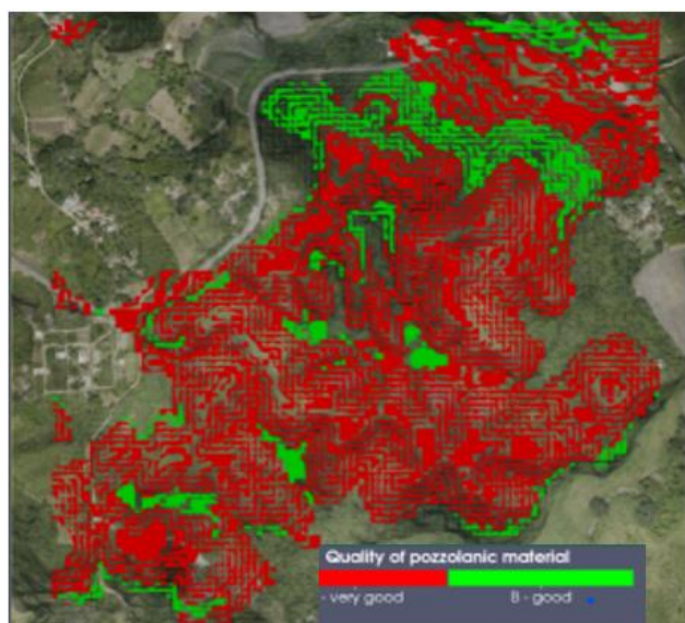
Figura 5. Calidad de material puzolánico: vista en planta.
