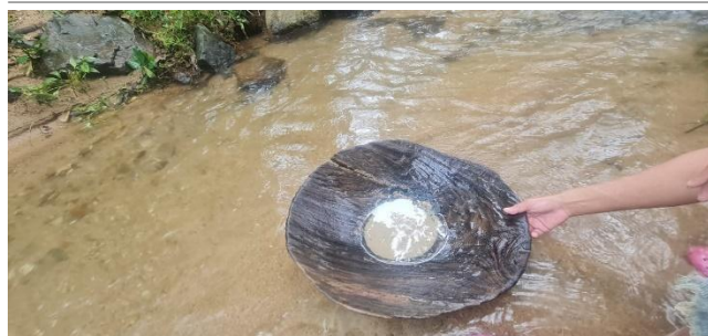
Figura 2. Batea utilizada para recuperación de oro de placer (arrastrado por escorrentía superficial, proveniente las descargas de rastras).
