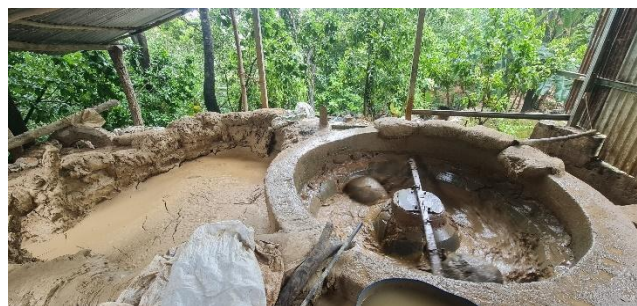
Figura 1. Rastra operativa, con laguna de descarga, ubicada en San Juan Arriba.
