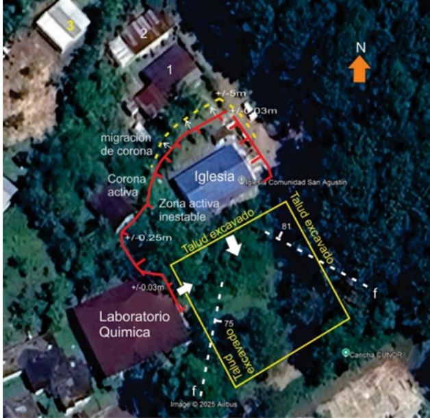
Figura 5 Migración de corona de deslizamiento de tipo rotacional.
